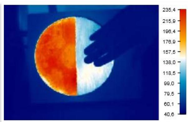
Теплоизолятор позволяет прикосновение к нагревательному элементу как минимум до 10 сек. без вреда для здоровья.
