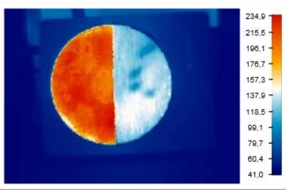
На термограмме видны следы прикосновения в течение 20 секунд.
