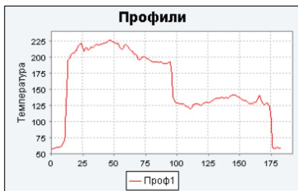
Нагревательный элемент бытовой электроплитки был покрыт слоем теплоизолятора БРОНЯ толщиной 2 мм. Температура поверхности нагревательного элемента, не покрытой теплоизоляционным покрытием, составляет в среднем по области 210 град С, максимальная - около 225 град С. Температура поверхности нагревательного элемента, покрытой теплоизоляционным покрытием, составляет в среднем по области 133 град С, максимальная - около 135 град С.
