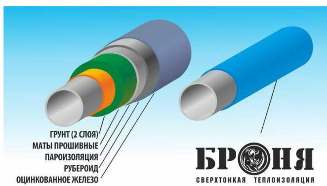
\* - толщина слоя Броня рассчитана исходя из расхода материала 1л на 1 м<sup>2</sup> толщиной 1 мм. Таким образом, для Ду 159мм (1 п.м. = 0,5м<sup>2</sup>) толщина слоя составит 2 мм. Расчет толщины изоляции исходя из норм СНиП 41-103-2000 показал толщину слоя Броня 1,6 мм.
