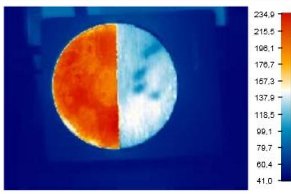
Теплоизолятор позволяет прикосновение к нагревательному элементу как минимум до 10 сек. без вреда для здоровья.
